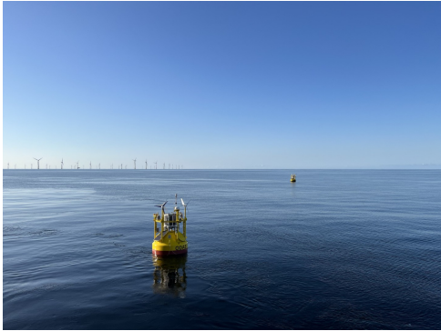
© Fraunhofer IWES Lidar-Boje am Messmast FINO 3 zur Verifizierung
