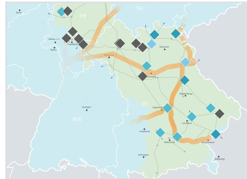
Abb. 8 – Voranalyseergebnis – Annahme flexibler Erzeugungsanlagen im TenneT-Netzgebiet, welche im Rahmen von Redispatch-Vorgängen in das Höchstspannungsnetz einspeisen können.
