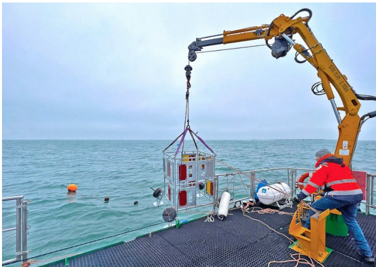
Ausbringung des Unterwasser-Landers vor der Insel Helgoland. © Fraunhofer IFAM
