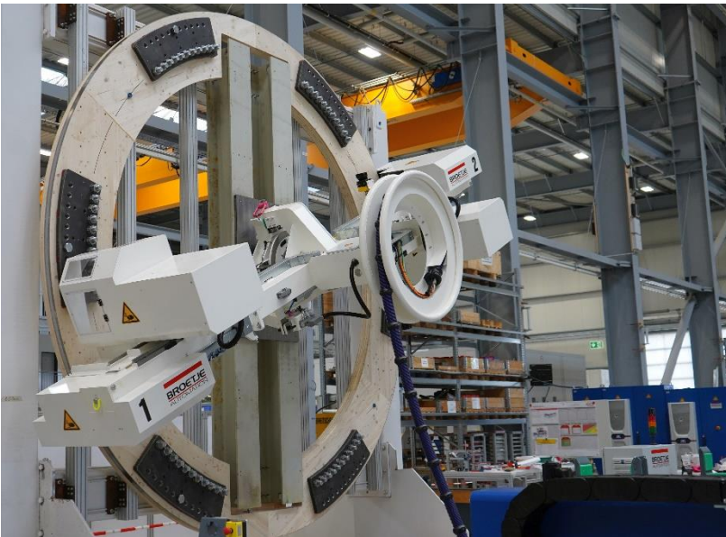
Bildunterschrift: Das Rotary Torque System ist als leichte, mobile Montageeinheit konzipiert, um sich optimal in die bestehende Produktionsumgebung einzufügen. (Foto: Broetje-Automation)
