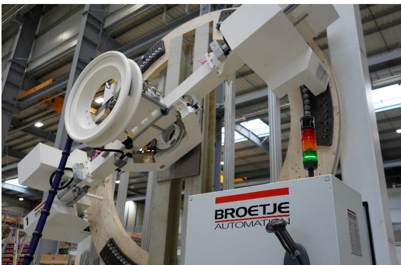
Bildunterschrift: Die Parallel angeordneten Verschraubungseinheiten arbeiten synchron und digital gesteuert..
