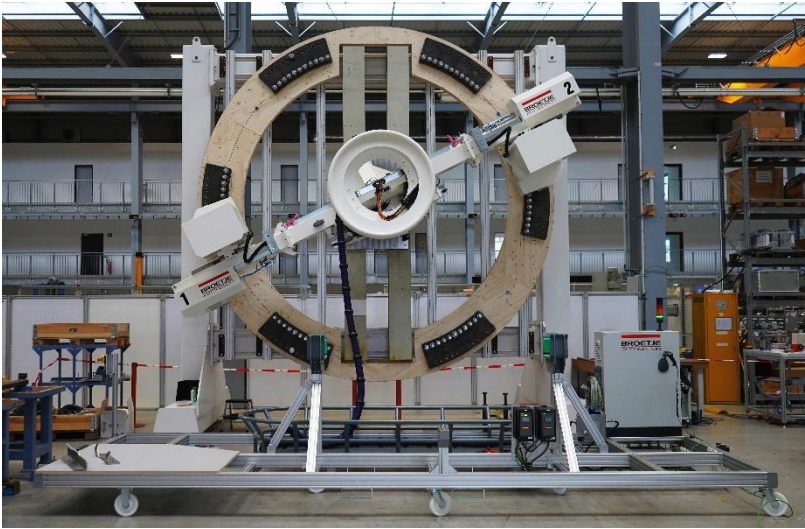
Bildunterschrift: Rotary Torque System zur Verschraubung von Windkraft-Bauteilen (Foto: Broetje-Automation)
