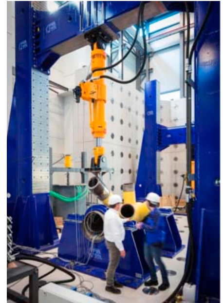
IWES-Prüfstand Hannover, Gussknoten im Test.
